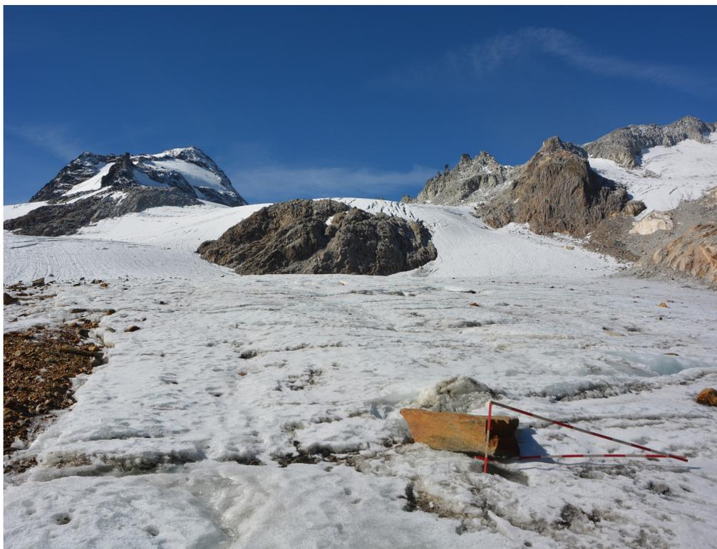
**Figura 17. Misura del bilancio di massa del ghiacciaio di Hohnsand il 21 settembre 2015 presso la palina ablatometrica non lontano dalla fronte a 2555m di quota. Dal 3 novembre 2014 la perdita complessiva di spessore è stata di 410 cm!**
