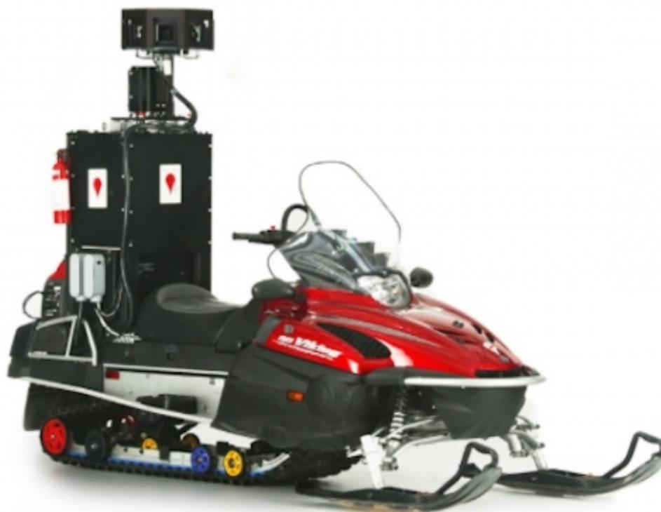
Nel corso di alcuni fine settimana e con l'aiuto di paletti di legno, nastro adesivo e hard disk, il tutto avvolto in giacche da sci per sopportare il clima polare, il team di Google è riuscito a montare con successo l'apparecchiatura di Street View su una **motoslitta**. Sciatori, snowboarder ed escursionisti possono ora esplorare Whistler Blackcomb Mountain e le piste innevate di molte stazioni sciistiche in tutto il mondo.
