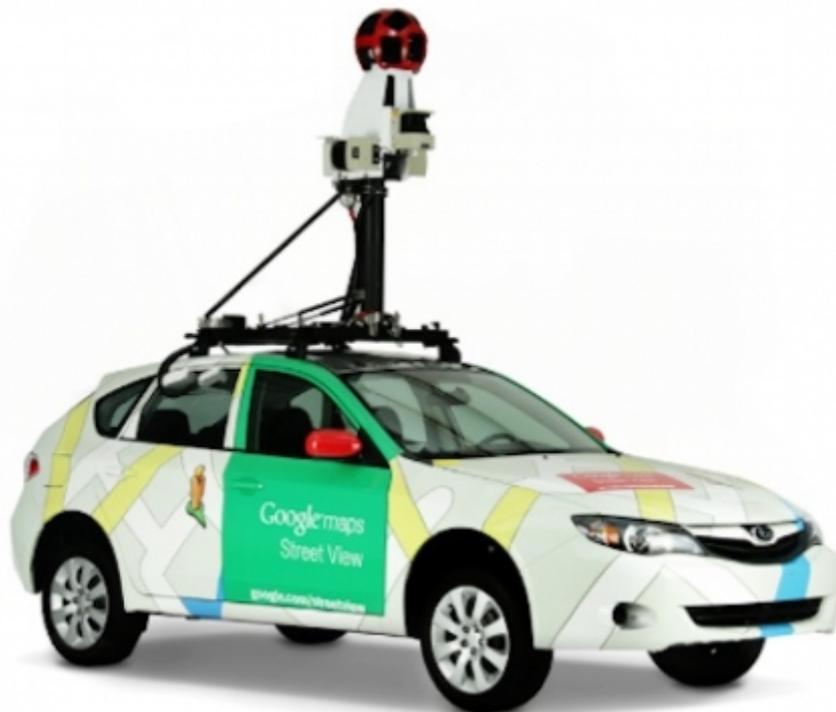
Diversi computer nel retro della macchina, fissati a macchine fotografiche, scanner laser e un dispositivo GPS sul tetto. Questa è **la macchina di Google Street view**. L’abbiamo conosciuta tutti anche perché è stata **avvistata più volte anche sulle strade del varesotto**.
