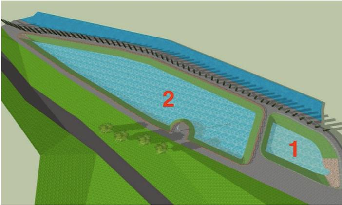
Ma se la pioggia dovesse essere di particolare intensità, parte del flusso che finirebbe nell'Olona sarà deviato in una seconda vasca, ben più ampia (2). **Saranno infatti 15.000 i metri cubi di acqua che potranno essere trattiene**ti qui dentro per poi essere pompate dentro il fiume, previa laminazione. Questa vasca, in particolare, in tempi di secca sarà comunque costantemente attraversata da un flusso di acqua.
