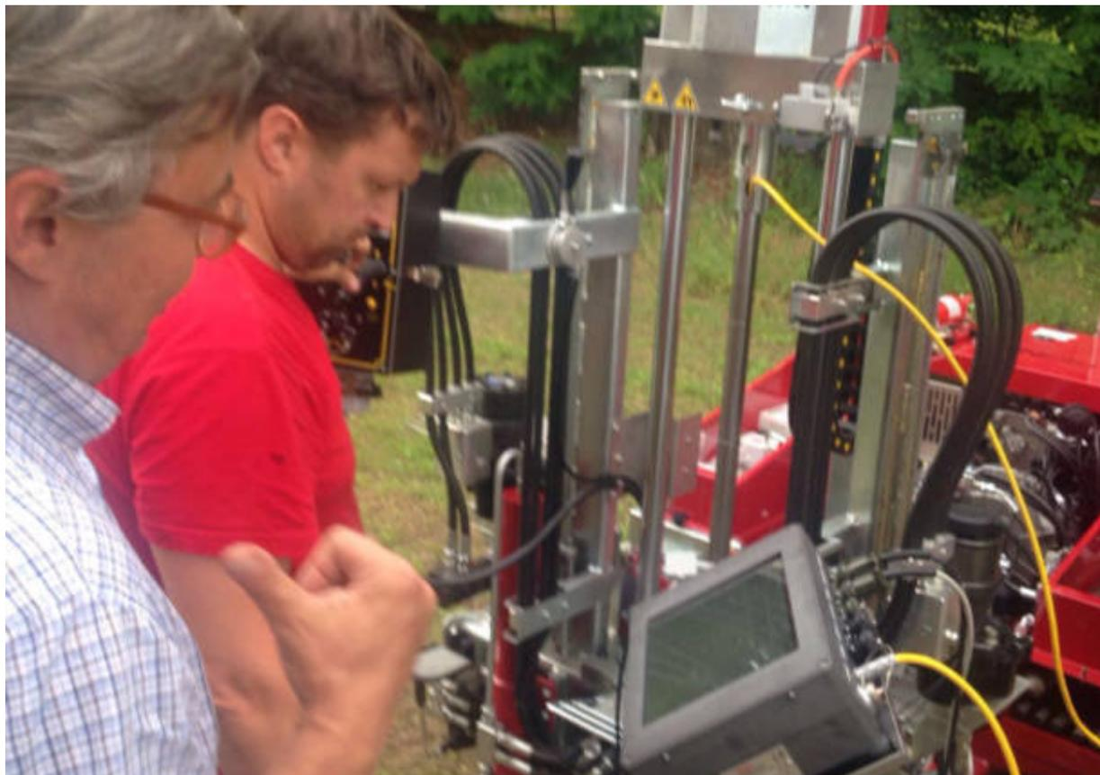
L'apparecchiatura per i sondaggi di profondità del terreno con i tecnici e gli ingegneri che stanno valutando i dati sul monitor
