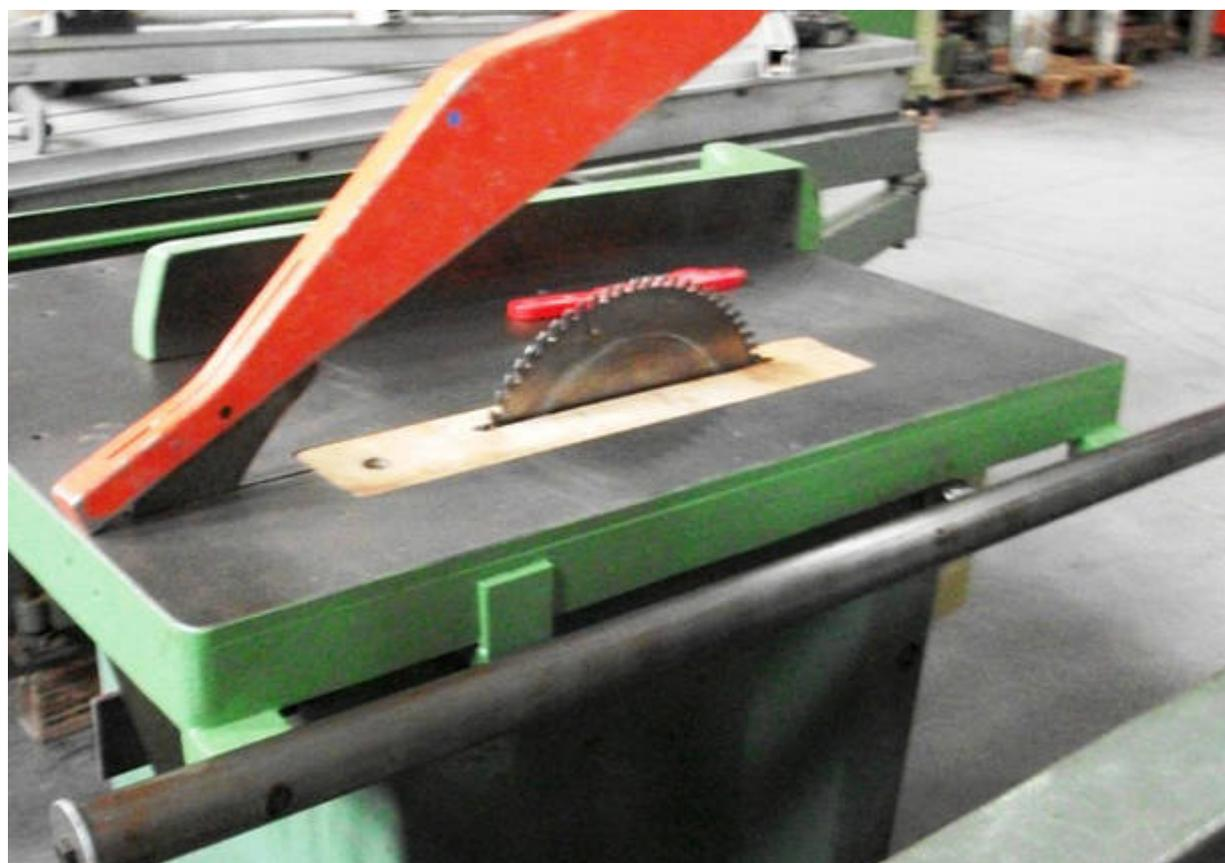
La **sega circolare** è uno strumento che permette tagli di grande precisione, che possono essere eseguiti su oggetti di materiali differenti tra cui prevalentemente il legno ma anche resine e agglomerati. Si tratta di un apparecchio estremamente versatile che permette di effettuare tagli obliqui o dritti, sia corti che lunghi.
