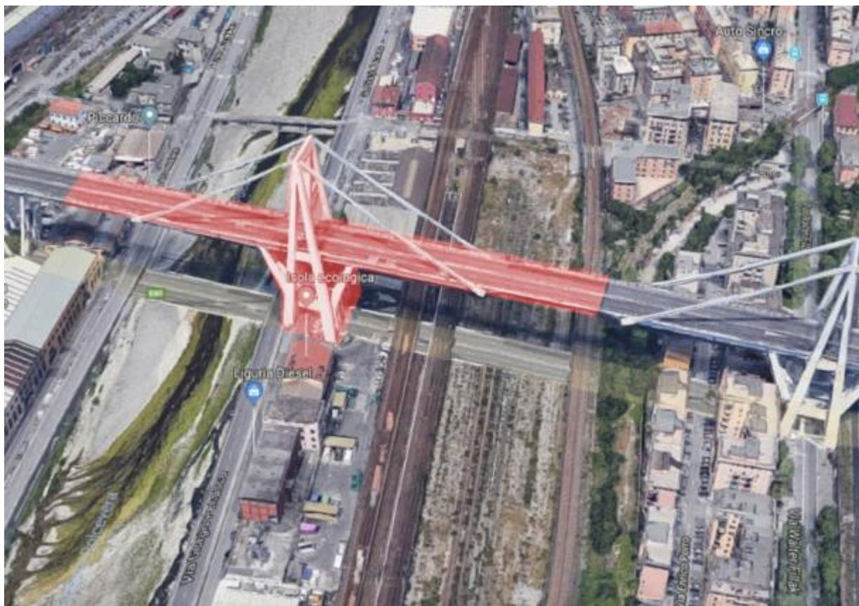
In relazione al crollo di parte del viadotto Polcevera sull’A10, Autostrade per l’Italia comunica che **sulla struttura – risalente agli anni ‘60 – erano in corso lavori di consolidamento della soletta del viadotto** e che, come da progetto, era stato installato **un carro-ponte per consentire lo svolgimento delle attività di manutenzione.**
