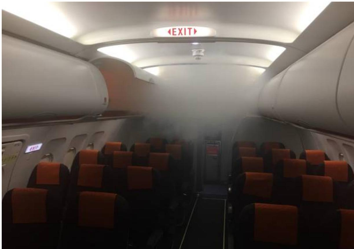
Simulazione di fumo in cabina nel *mock-up* dell'Airbus
