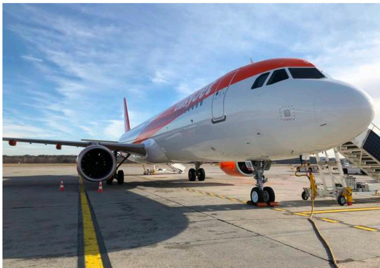
Sono aerei performanti, con un impatto ambientale minore. I nuovi **Airbus A321 neo** – parte della famiglia **A320 neo**, che dovrebbe sostituire nel tempo i più vecchi A320 – sono aeromobili caratterizzati dalla *new engine option*, ovvero dalla presenza di **motori più grandi ed efficienti**. **Rispetto agli A319 producono il 15% di emissioni in meno, e il 50% in meno di impatto acustico.**
