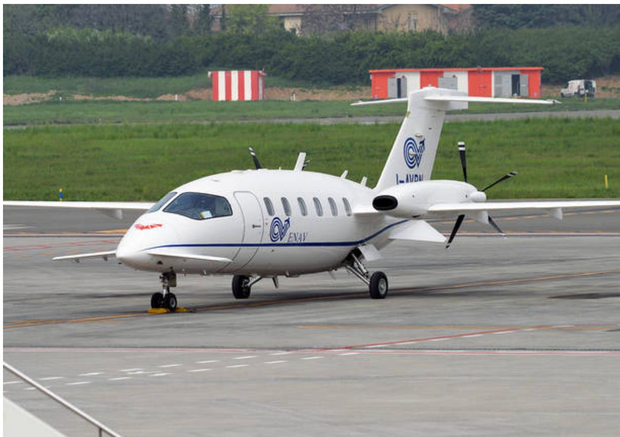
**A bassa quota si annuncia con un ronzio insistente**, causato dai due motori turboelica. È il **Piaggio P180** dell'Enav, l'aereo che viene utilizzato per verificare e "tarare" i radiofari e le altre apparecchiature installate a terra che "guidano" gli aerei nell'avvicinamento alle piste di un aeroporto.
