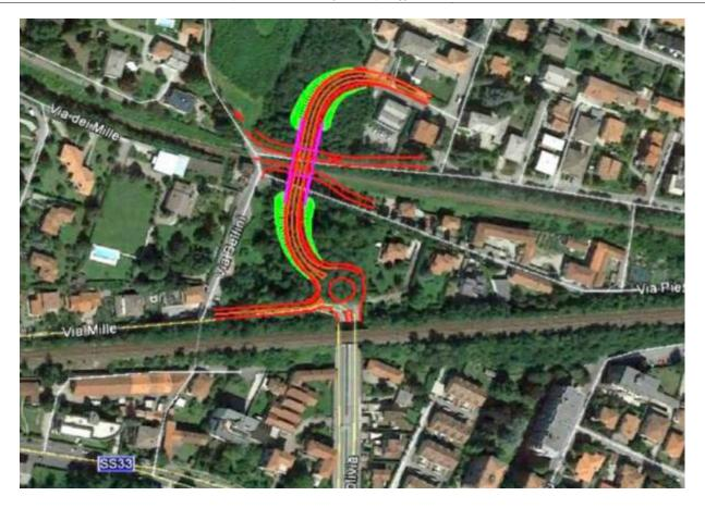
Il progetto del sottopasso di via Bolivia, sostitutivo del passaggio a livello nella zona bassa di Crenna
