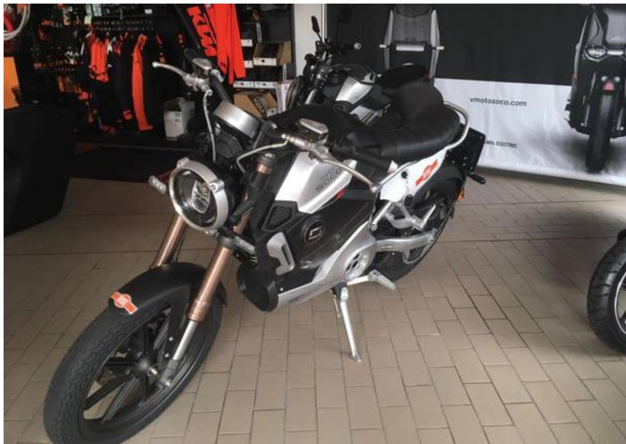
La moto elettrica **TCMax** è il **modello da 125cc** che ha un motore centrale ad alta potenza fissato al telaio e collegato alla ruota posteriore da una silenziosissima trasmissione a cinghia dentata che distribuisce in maniera ottimale la potenza tra ruota anteriore e ruota posteriore.
